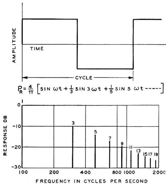
البته شکل واقعی این موج ترکیبی (با توجه به جمع جملات سری هارمونیک اشاره شده در شکل ۳) در شکل ۴ نمایش داده شده است. این شکل توسط یک اسیلوسکوپ نگاشته شده است. در سایت [www.IranAcoustic.com](http://www.IranAcoustic.com) (قسمت مقاله‌ها) می‌توانید نمونه‌های صوتی و ویدئویی مربوطه را
