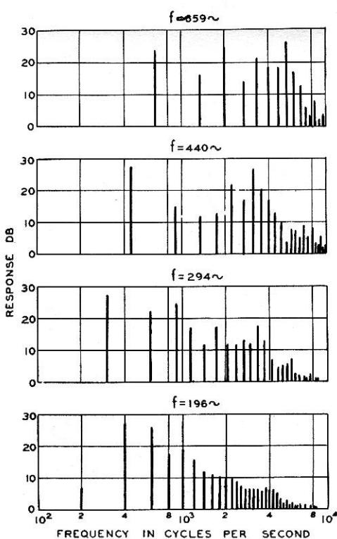
در شکل ۶ به بررسی طیفی سه نت انتخابی از ساز پیانو می‌پردازیم. ساختار طیفی نتها در پیانو، به سرعت برخورد چکش با سیم‌ها و سرعت چکش نیز به سرعت فشرده شدن کلاوه‌ها بستگی دارد. در فرکانس‌های بالاتر دامنه هارمونیک‌ها با تغییر فرکانس، به سرعت تغییر می‌ابد. و فرق‌های قابل ملاحظه‌ای بین طیفهای فرکانس‌های بالا و پائین در این ساز وجود دارد.
